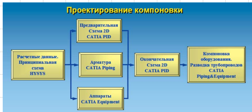
Рис. 4. Упрощенная схема проектирования компоновки ВРУ
